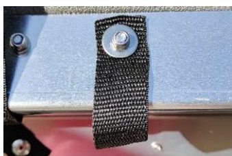
BILD 7. Du kan fästa en tyngd på ca. 5 kg i ögglan längs bak under mattan, ifall båtplatsen är trång. Detta förbättrar även mattans egenskaper att styra in båten rätt, men minskar en del på flytkraften.
