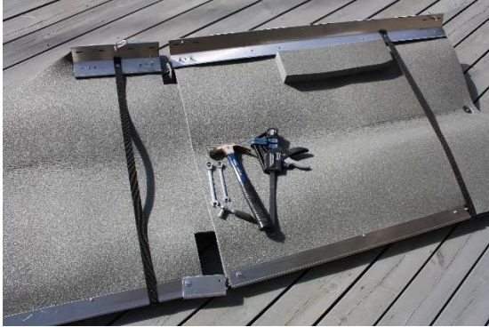
KUVA 1. Aloita työ asettelemalla lohkot tasaiselle alustalle keskeltä taitettuna peräkkäin järjestyksessä etulohko, välilohko/lohkot ja takalohko. Käsittele solumuovia varovasti.
